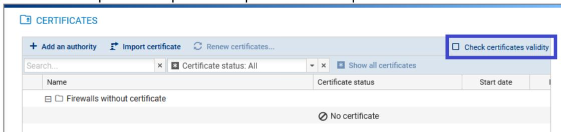
2. Si besoin, configurez pour chaque certificat quelle adresse IP locale utiliser pour effectuer la vérification et la fréquence de vérification. Pour cela :
