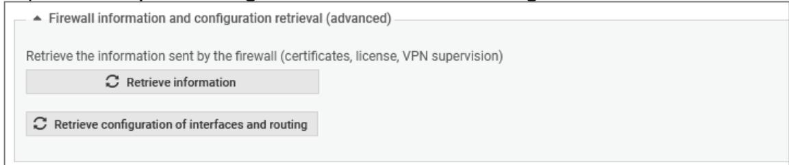
Lorsque vous forcez la récupération des interfaces d'un firewall, si le firewall possède des interfaces IPsec virtuelles (VTI), nous vous recommandons de consulter les Journaux du serveur pour vérifier qu'il n'y a pas de conflit de nom d'interface ou d'adresse IP et de masque entre les interfaces IPsec créées sur SMC et les interfaces IPsec créées sur le firewall. Des noms ou adresses identiques pourraient supprimer des interfaces utilisées dans des routes ou règles.
